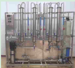
UF+RO膜分离水处理装置
