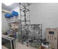
脉冲折流板萃取柱系统
